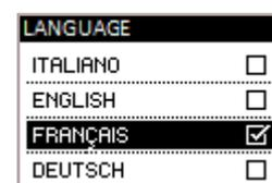
Sélectionner, par le biais des touches (↑) (↓) la langue que l'on compte utiliser comme standard d'affichage. Pression de la touche (OK) pour confirmer et passage à la page-écran suivante. Afin de pouvoir opérer correctement, télécommande doit entrer en interface avec la carte électronique présente à l'intérieur du produit. Pour cette raison, l'afficheur montre un message de première installation.
