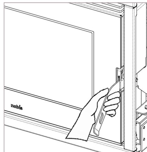
Soulever la «main froide» fournie avec le produit, pour débloquer la porte et permettre l'ouverture de la porte feu, comme dans la figure ci-dessous :
