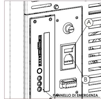
L'interrupteur "I/O" (A) dans la figure ci-dessus doit être positionné sur "I". En cas de non-alimentation, contrôler l'état du fusible qui se situe dans le boîtier sous l'interrupteur (B) (fusible de 4A configuration EU). Durant la période d'inutilisation, on conseille de retirer le câble d'alimentation de l'appareil, tout comme les piles de télécommande.
