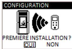
En cas de première utilisation de télécommande choisir **OUI** avec les touches de sélection (↑) (↓) (OK). Pression de la touche pour confirmer et passage à la page-écran suivante. Suivre l'instruction guide pour lier via radio l'appareil à l'afficheur, comme reporté dans la figure ci-dessous.
