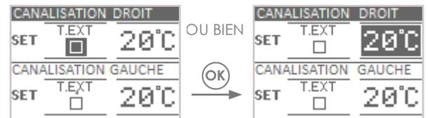
Pression des touches **↑** **↓** pour activer/désactiver le flag si on souhaite gérer la température de la zone à canaliser à l'aide d'un thermostat externe (non fourni). Touche **OK** pour confirmation.
