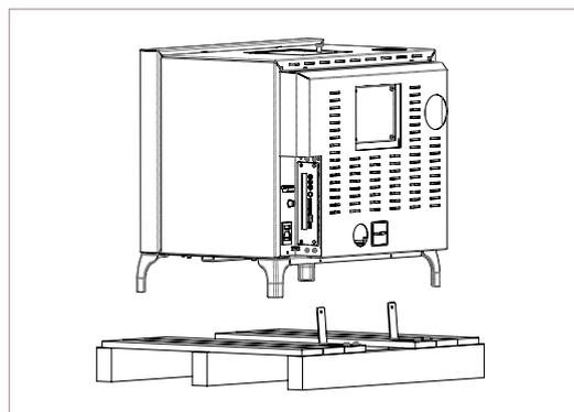
Positionner l'appareil et procéder à son raccordement à la cheminée.
