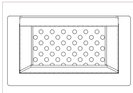
**i** Éliminez les résidus qui se déposent sur le fond et sur les côtés du brasier afin de toujours avoir les trous libres avant l'allumage. Utilisez un aspirateur à cendres. Les incrustations difficiles à éliminer peuvent être causées par le type de granulés ou par un réglage non optimal de l'appareil.
