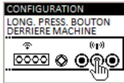
Garder enfoncée pendant quelques secondes la touche de communication radio (📶) de la carte électronique, qui se situe sur la partie arrière du produit, pour démarrer la procédure de recherche unité.
