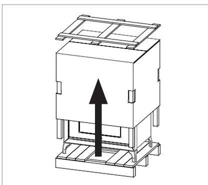
Pour retirer le luminaire de la palette, il est nécessaire d'enlever les supports qui le fixent à la palette afin de libérer le luminaire de la base en bois.
