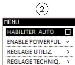
Cette programmation empêche la gestion manuelle de la ventilation en option, à l'exception de la programmation ventilation à OFF. Dans ce cas, l'appareil gère de façon autonome uniquement la puissance au foyer. La ventilation reste désactivée.
